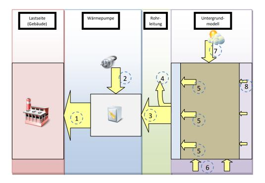
In obiger Abbildung sind die Energieströme für den Heizfall als gelbe Pfeile dargestellt. Angegeben wird die Lastseite, d.h. die benötigte Energie in einem gewissen Zeitraum. Der Zeitraum ist typsicherweise auf Monatsbasis und spiegelt den Jahreszeitlich variierenden Bedarf wider, z.B., 6000 kWh im Januar, 5000 kWh im Februar usw.
